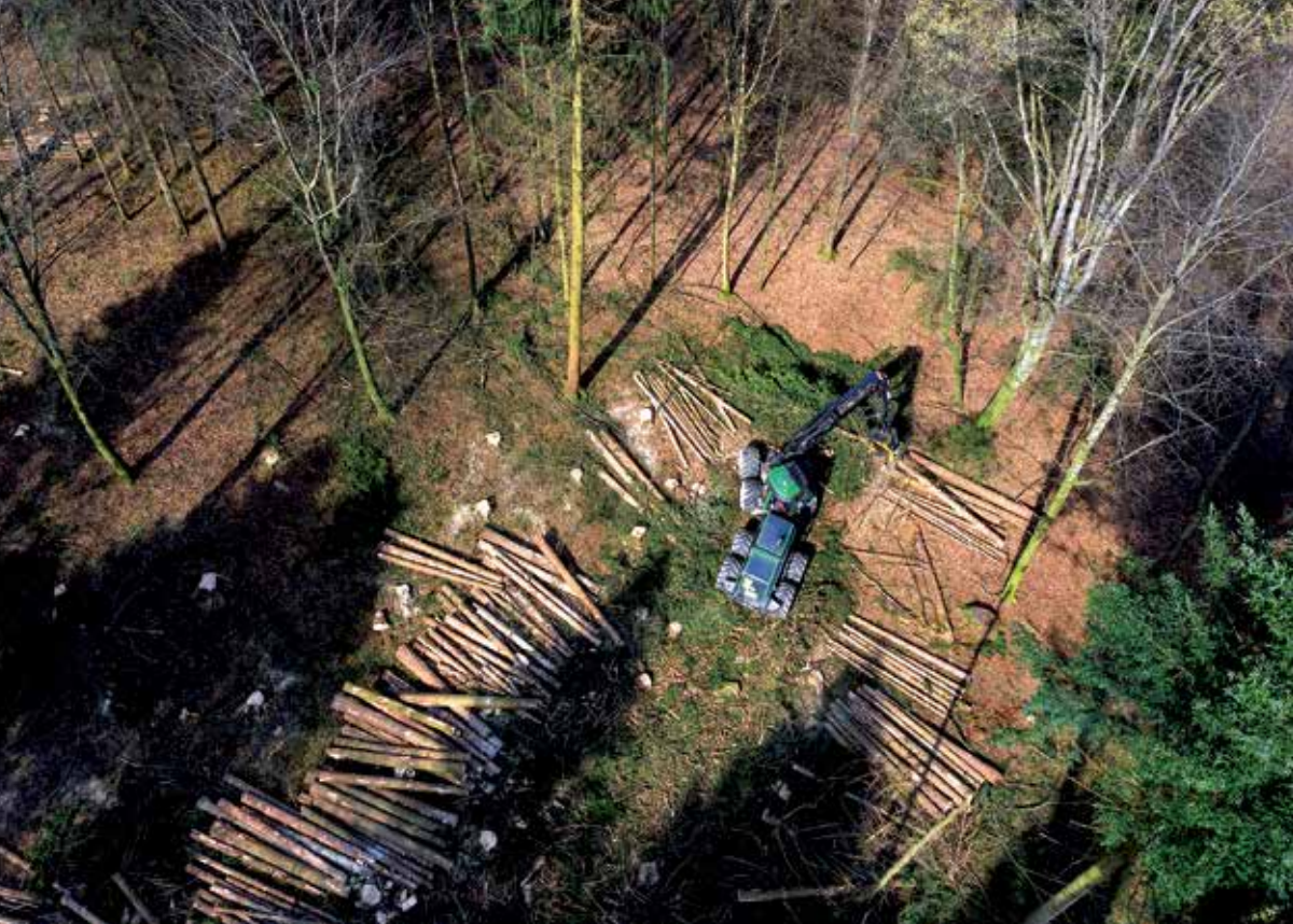
Vollernter an der Arbeit auf einer Rückegasse.
