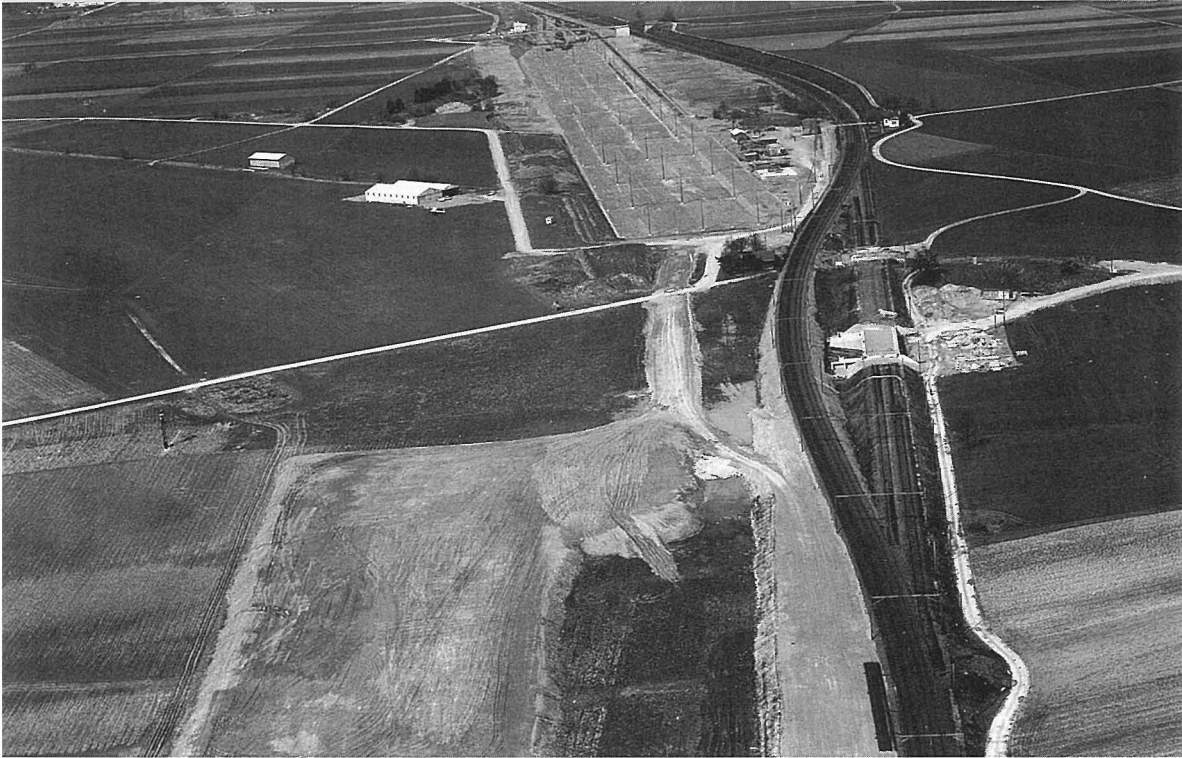
Geleisedoppelspur zwischen Dietikon und Killwangen mit provisorischer Geleiseumfahrung für die Mutschellenstrassen-Unterführung zur N1. Oben 1. Etappe Rangierbahnhof Limmattal, links davon das Flugfeld Spreitenbach mit dem Hangar. Der Maienweg durchquert die Landschaft und bildet die Grenze zum Kanton Aargau. An Maienweg und Bahn das Flugplatzrestaurant. Flugaufnahme 1968. Foto-Servis SBB, Bern
