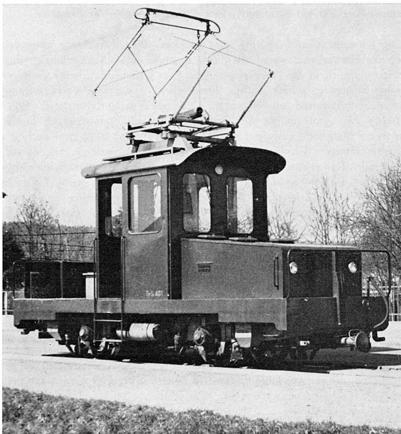
Abb. 14. Draisine der Station Dietikon. Ein umgebauter alter Motorwagen.
